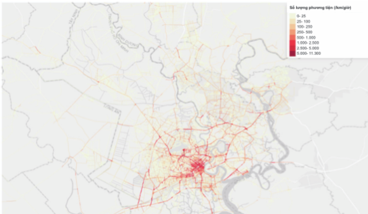
Hình 2.29a. Minh họa mật độ giao thông TP Hồ Chí Minh thông qua dữ liệu CVTS
